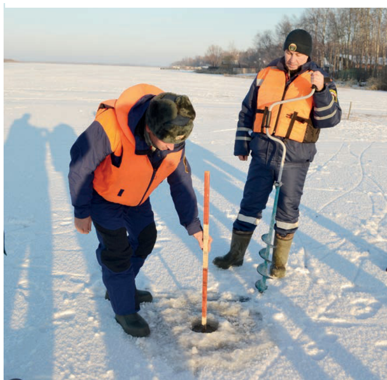
Специалисты ГИМС проводят замер толщины льда на Костромском разливе
