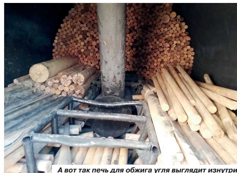
А вот так печь для обжига угля выглядит изнутри
