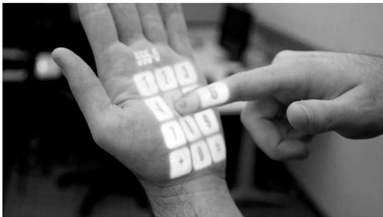
Одновременно с выходом нового iPhone Microsoft сказала свое слово в деле совершенствования интерфейса, представив устройство OmniTouch. Это камера, сочетающая в себе функции проектора и сканера. В дисплей OmniTouch превращает любую поверхность — будь то ладонь или поверхность стола.
